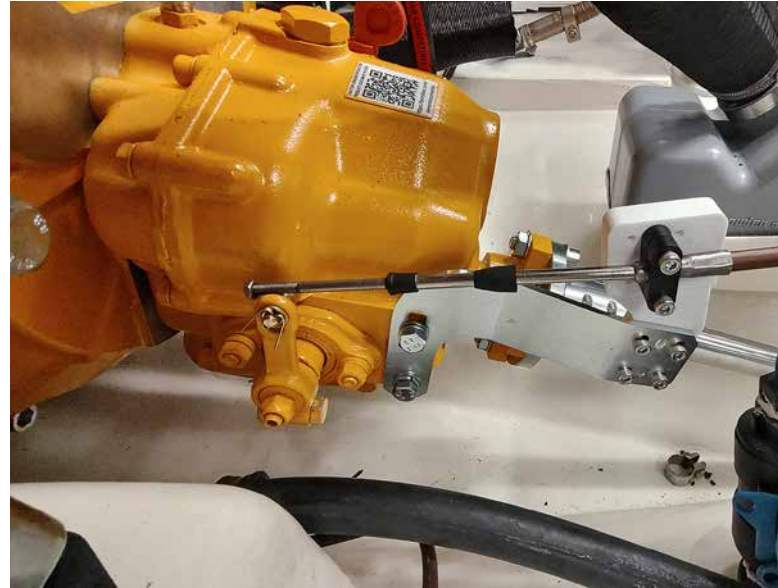
3D tulostettu kulma-adapterin prototyyppi vaihdekaapelille
