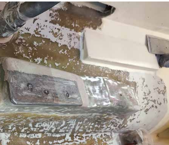
Etutassujen korotuspalat massattuna ja ruuvattuna konepetiin ennen päällekuidutusta
