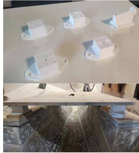
3D-tulostetut moottorin tassut ja linjaustyökalu sekä sapluuna käytössä
