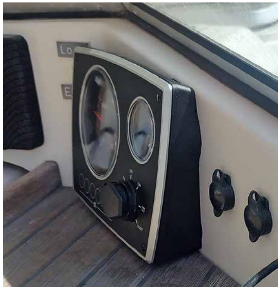
3D tulostettu mittaritaulun adapteri ja akselinkeskittin.
